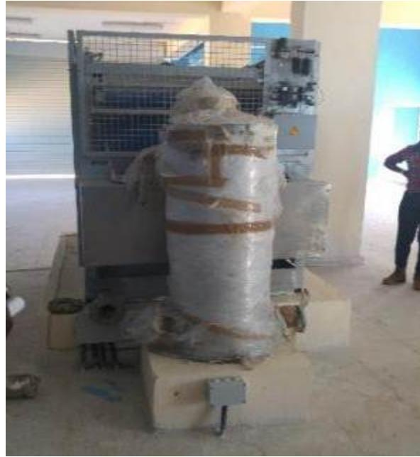
**FOTO 13:** Compactador paara el Secado de Lodos en la Planta de Tratamiento de Aguas Residuales Luyanó IV, Cuba noviembre de 2016.
